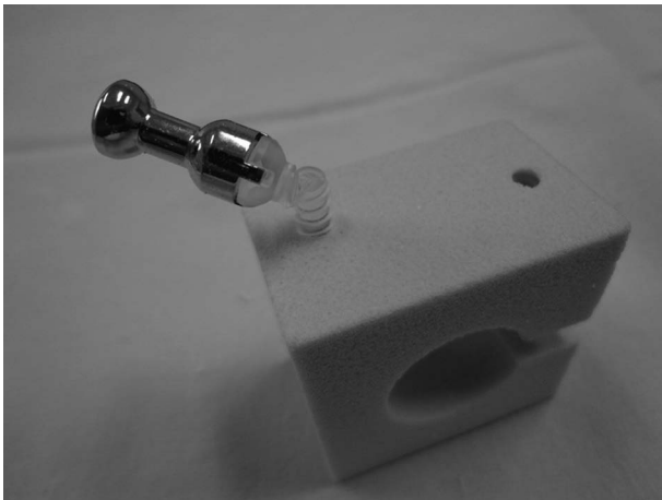
Рис. 7. Разрушение винта при приложении избыточного усилия на закручивании
